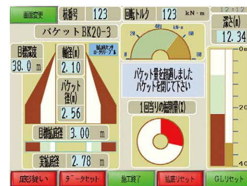
拡底部掘削時
